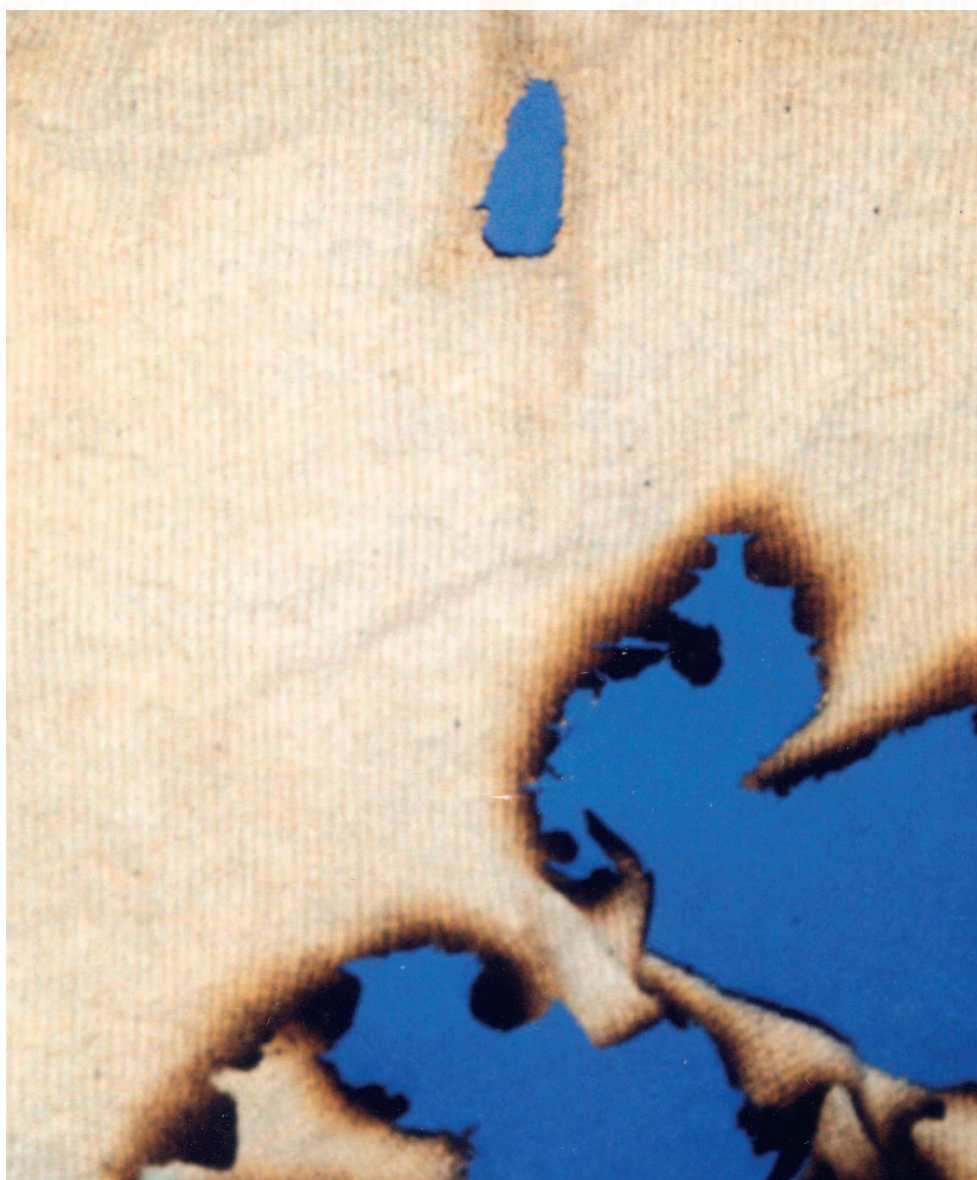
Bild 4: Lappen, der nach dem Abbruch des Versuchs deutliche Brandnester aufweist
