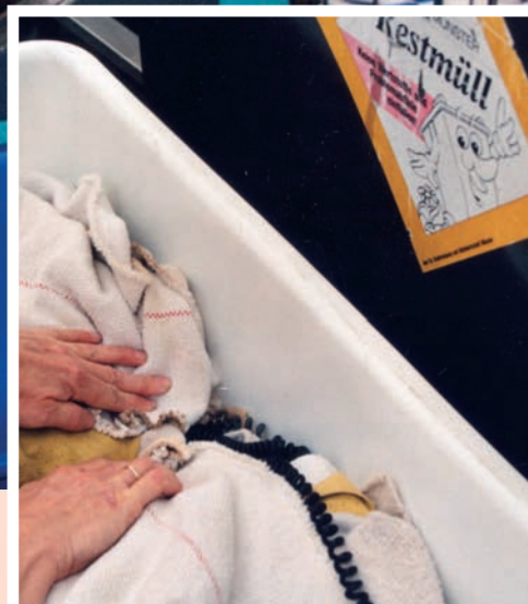
Bild 3: Im Modellversuch wurde die Wäsche unmittelbar nach dem Trocknen in die Wanne gegeben. Die Temperatur im Inneren des Wäschestapels wurde fortlaufend gemessen.
