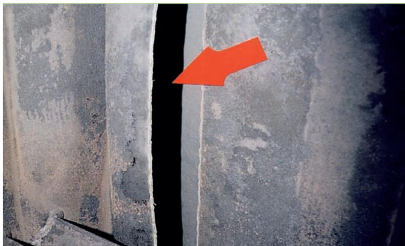
**Bild 2:** An dieser Stelle im Brennraum riss eine Schweißnaht des Kessels.
