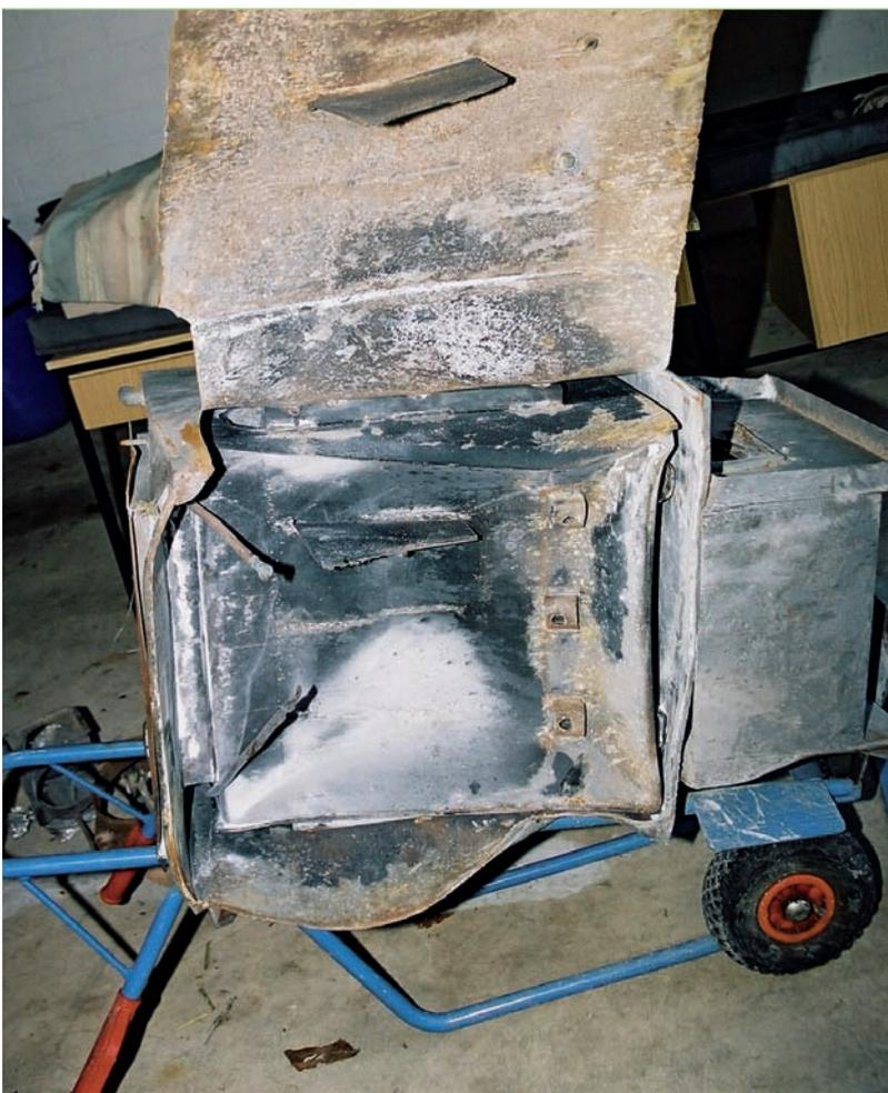
**Bild 4:** Das mehrere Millimeter starke Stahlblech des Kessels riss aufgrund des Überdrucks wie Papier auf.
