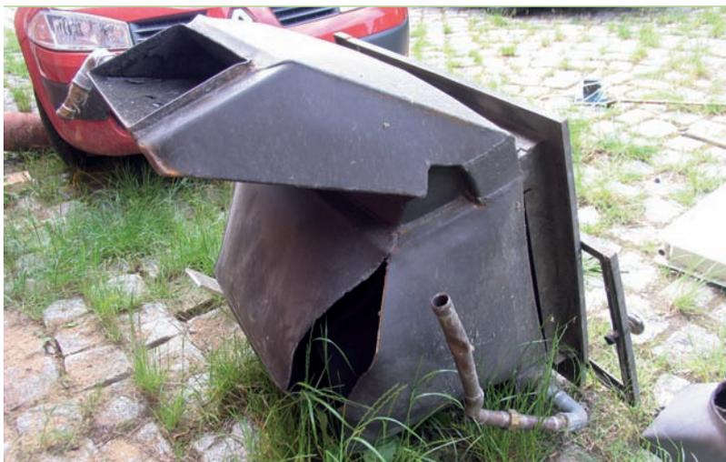
**Bild 7:** Die Schweißnaht des Kessels riss an der hinteren Ecke auf einer Länge von mehreren Dezimetern auf.
