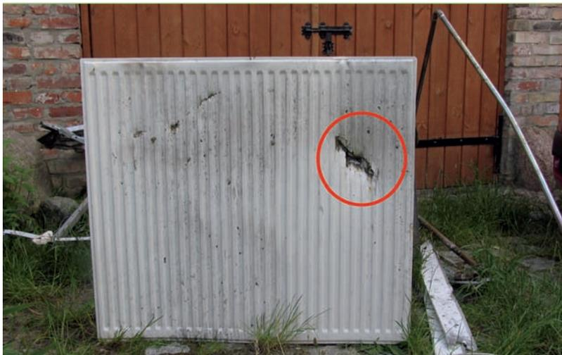
**Bild 6:** Der Heizkörper, der vom Kessel durchschlagen wurde.
