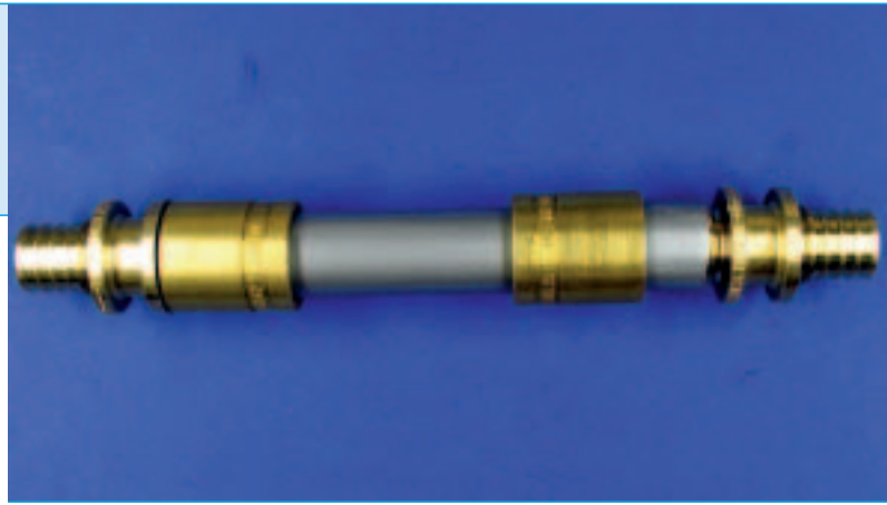
Bild 7: Auch bei diesem Schiebehülsensystem kann eine vorübergehende Dichtheit der Verbindung ohne den abschließenden Schritt der Verpressung eine ordnungsgemäße Installation vortäuschen.
