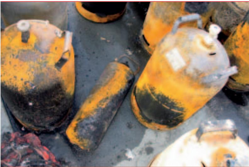
**Bild 3:** Die Flüssiggasflaschen haben zum Teil Dehnungsrisse.
