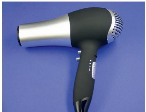
Bild 3 | Brand zur nachtschlafenden Zeit in einem Wohnhaus. Ein Haartrockner schaltet sich aufgrund eines mangelhaften Schalters selbstständig ein. Dieser Fehler führte später zu einem Produktrückruf des Anbieters. Das zweite Bild zeigt ein Vergleichsgerät.
