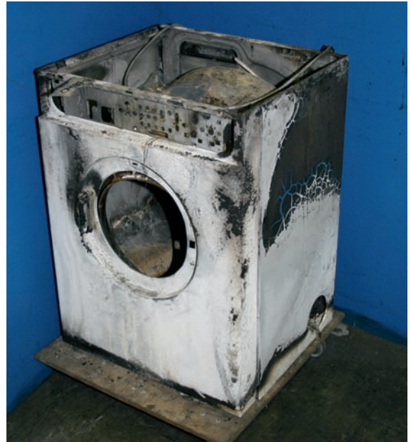
Bild 2 | Brand eines Wäschetrockners im Keller eines Doppelhauses. Der Trockner geriet aufgrund eines technischen Defektes in Brand. Das zweite Bild zeigt den Wäschetrockner im Labor des IFS.
