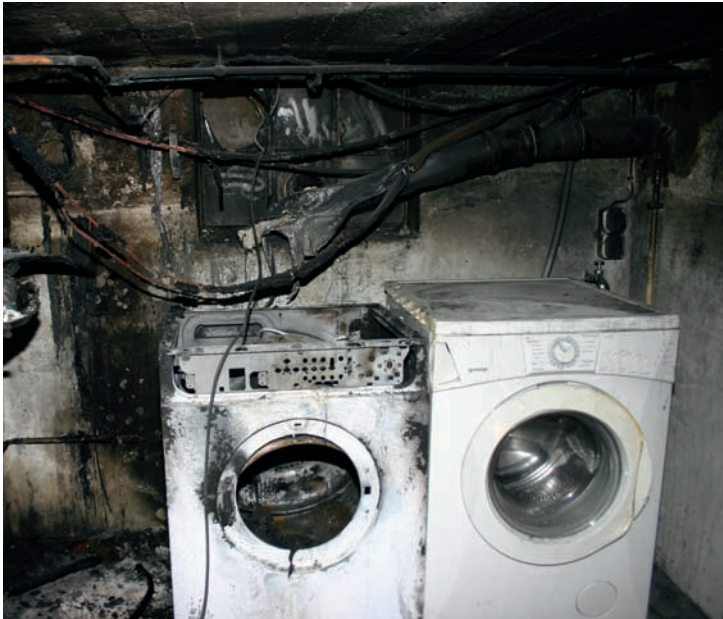
Bild 2 | Brand eines Wäschetrockners im Keller eines Doppelhauses. Der Trockner geriet aufgrund eines technischen Defektes in Brand. Das zweite Bild zeigt den Wäschetrockner im Labor des IFS.
