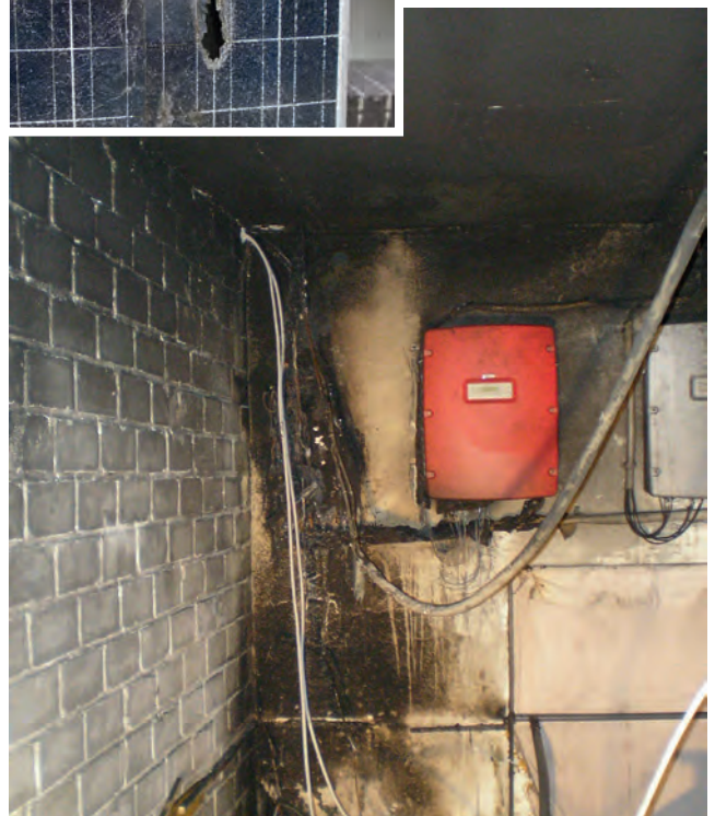
Bild 2 | Lichtbogenschaden Bild 3 | Bauteilversagen in der Wechselrichterverteilung
