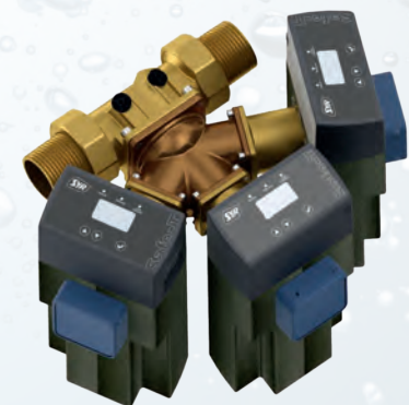
Bild 5c | Drei Leckagedetektoren Safe-T-connect lassen sich über einen Dreifachverteiler zu einer Triplexeinheit kombinieren. Dadurch kann der Volumenstrom verdreifacht werden.
