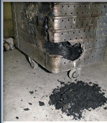
**Bild 2** | Brandherd im unteren Bereich des Wäschewagens, dessen Aluminium-Wandung abgeschmolzen ist
