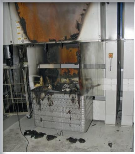
**Bild 1** | Brandherd in einem Wäschewagen, der an der Trocknungsanlage der Großwäscherei abgestellt war
