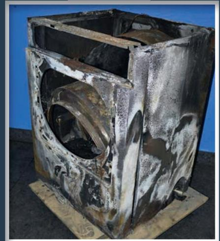
**Bild 5** | Schadenfall 2 – Untersuchung eines Wäschetrockners im Labor des IFS
