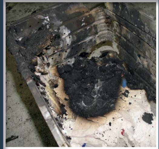
**Bild 3** | Nach dem partiellen Räumen der Wäsche zeigt sich der Brandherd im unteren Bereich
