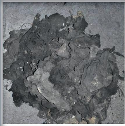
**Bild 6** | Schadenfall 2 – Aus der Trommel des im Labor des IFS untersuchten Wäschetrockners wurden angebrannte Textilien geborgen. Sie wurden hinsichtlich des Fettgehaltes und des Fettsäuremusters analysiert.
