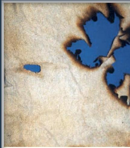
**Bild 4** | Schadenfall 1 – Fettverschmutzter Lappen mit Brandlöchern infolge von Selbstentzündung
