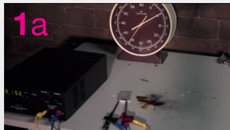
Bilder 1a bis 1d | Fotostrecke zu einem Versuch, in welchem ein mehrzelliger Lithium-Polymer-Akkumulator, wie er im Modellbau verwendet wird, zu hohen Ladeströmen und -spannungen ausgesetzt wird:
