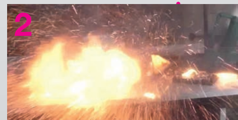
Bild 2 | Dokumentation der heftigen Reaktion eines 18650-Lithium-Ionen-Akkumulators bei zu hohen Temperaturen. Zugeführte Wärme von einer externen Quelle lässt den Akku letztendlich explodieren und in Flammen aufgehen.
