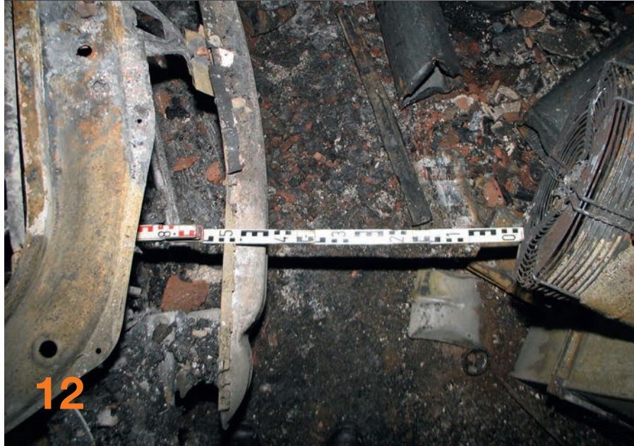
Bild 12 | Vgl. vorige Abbildung: Der Abstand des Ofens zu den Resten des Fahrzeugs (Typ Renault „Vel-Satis“) beträgt ca. 45 cm.
