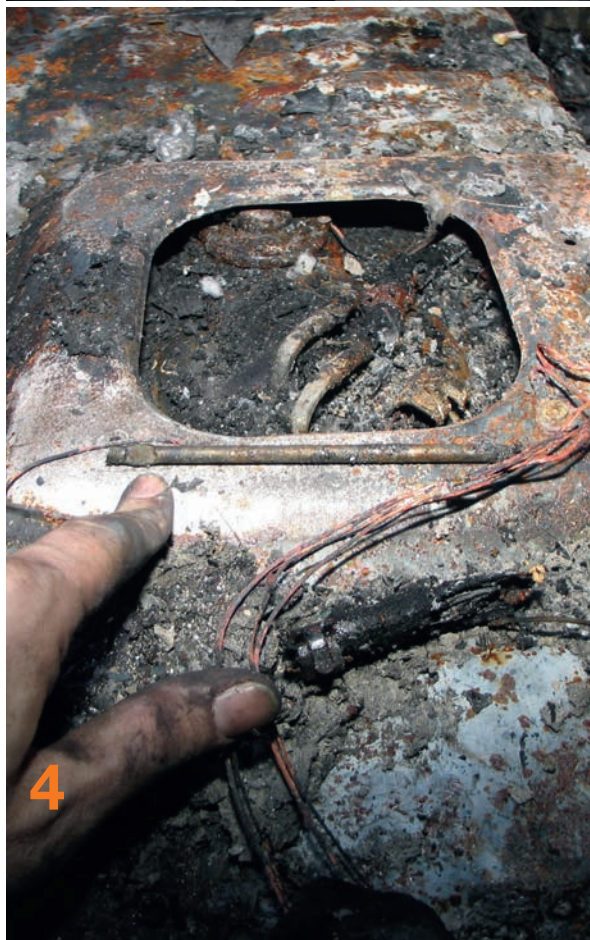
Bild 3 | Das verwendete Überbrückungskabel verläuft ausgehend von der Batterie entlang des linken Kotflügels und im Bereich der A-Säule in die Fahrkastzelle.
