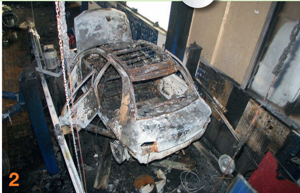
Bild 2 | Blick auf das in Bild 1 mit dem Kreis gezeigte Fahrzeug. Auffällig ist außerdem an dem ansonsten sehr gleichmäßig brandgezehrten Fahrzeug, dass die Fahrzeugfront weniger stark in Mitleidenschaft gezogen wurde und das Fahrzeugdach im Bereich oberhalb der C-Säule die stärksten Brandzehrungen trägt. So ist allgemein die Lackierung zwar verascht, fehlt aber im Dachbereich oberhalb der C-Säule völlig. Dort ist die Karosserie zudem stark ausgeglüht. ▶
