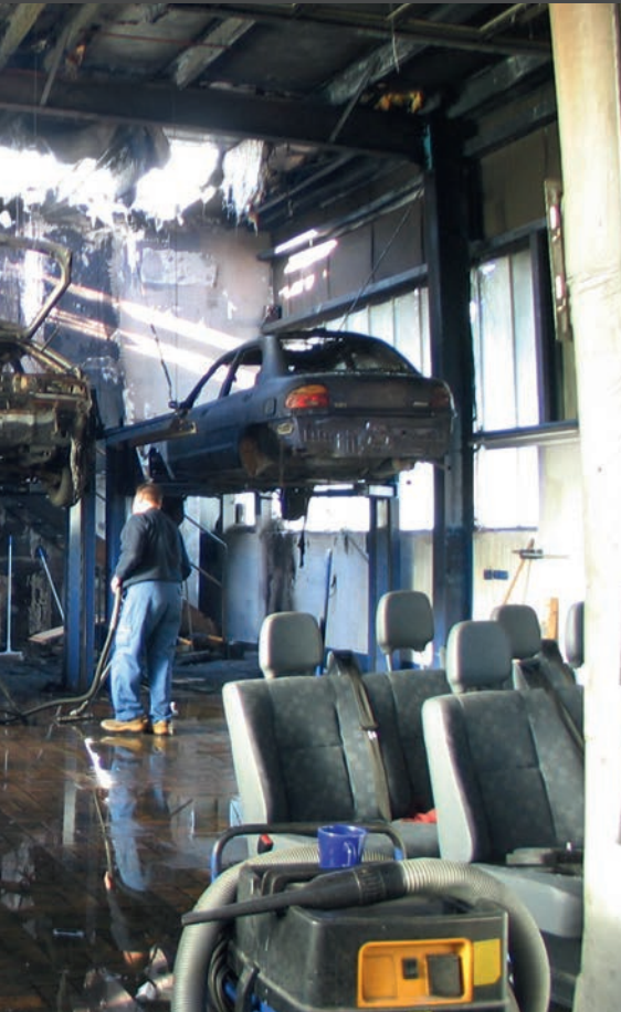
Bild 2 | Blick auf das in Bild 1 mit dem Kreis gezeigte Fahrzeug. Auffällig ist außerdem an dem ansonsten sehr gleichmäßig brandgezehrten Fahrzeug, dass die Fahrzeugfront weniger stark in Mitleidenschaft gezogen wurde und das Fahrzeugdach im Bereich oberhalb der C-Säule die stärksten Brandzehrungen trägt. So ist allgemein die Lackierung zwar verascht, fehlt aber im Dachbereich oberhalb der C-Säule völlig. Dort ist die Karosserie zudem stark ausgeglüht. ▶
