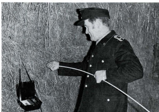
Bild 8. Temperaturmessungen im Heustapel. Die Tragetasche mit dem Meßkasten kann umgehängt oder wie hier am Heustapel aufgehängt werden.
