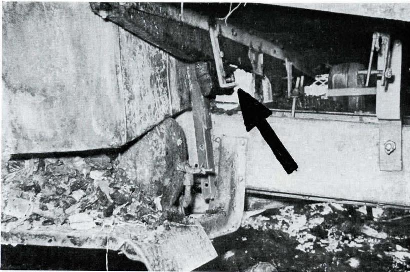
Bild 4. Brandherd im Bereich des Batteriekabels unter dem Führerhaus.
