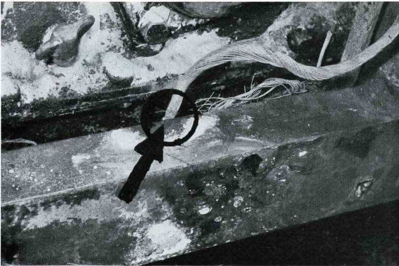
Bild 10. Batteriekabel scheuerte am Chassisrahmen.
