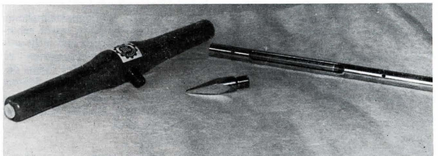
Bild 1. Thermomechanische Sonde. Stoßspitze, Stahlrohr mit Thermometer und Stoßgriff
