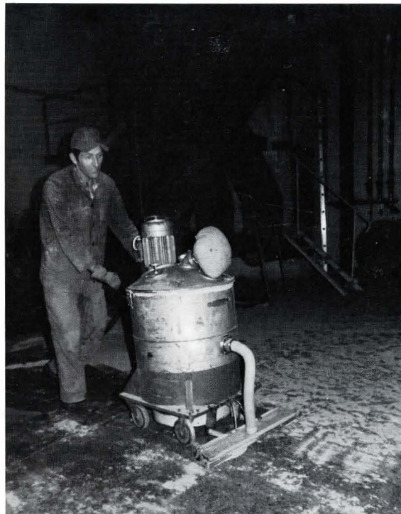
Bild 3. Beseitigung von Staubablagerungen in Betriebsräumen.
