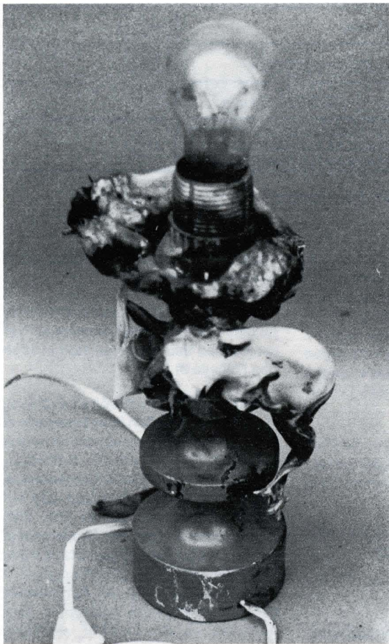
Bild 1. Eine zerplatze Glühlampe – hier erneuert – setzte die Leuchte mit dem Kunststofffuß und den Lampenschirm in Brand.
