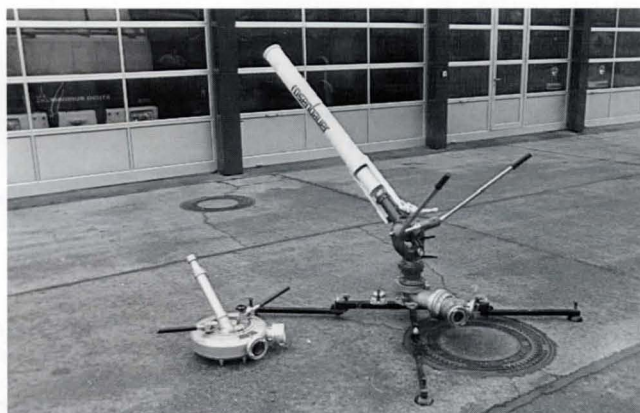
Bild 2. Links – Wasserring-Monitor, Leistung: 1200 l/min. Rechts – Schaum-Wasser-Werfer mobil, Leistung: 1600 l/min Wasser, 16 m 3 /min Schaum.
