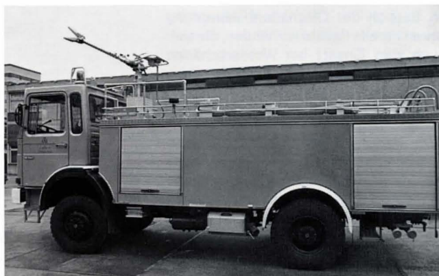
Bild 1. Schaum-Wasserwerfer 1000–1200 l/min, fest eingebaut in einem Tank-Löschfahrzeug TLF 24/50.
