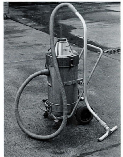
Bild 6. Hochleistungs-Wassersauger zur gleichzeitigen Aufnahme und Abgabe von Wasser.
