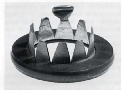
Abb. 4. Sprengkapselhalterung und Berstscheibe nach der Zündung.
