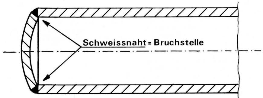
Bild 2. Schweißnahtausführung bei dem vom Schaden betroffenen Rohr.
