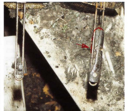
Abb. 5: Griff des linken Korbes vollständig verbrannt
