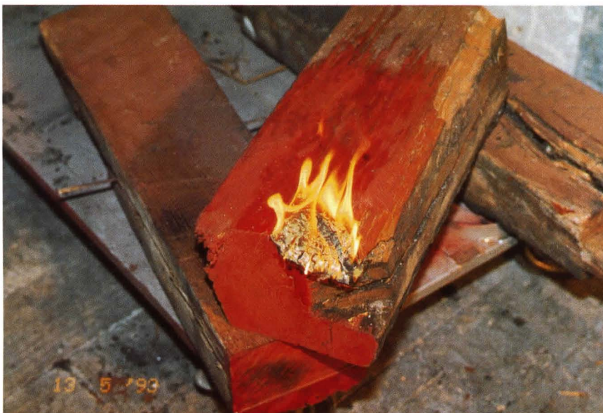
Bild 5: 2. Versuch-Versuchsende nach 4 Minuten – Das Holz brennt selbständig weiter
