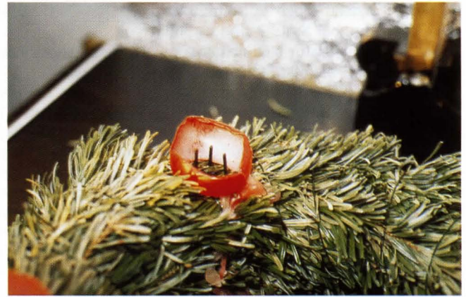
Bild 2: Deutlich ist die Kerzenhalterkonstruktion zu erkennen. Keine „Pfanne“ schützt vor dem Durchbrennen
