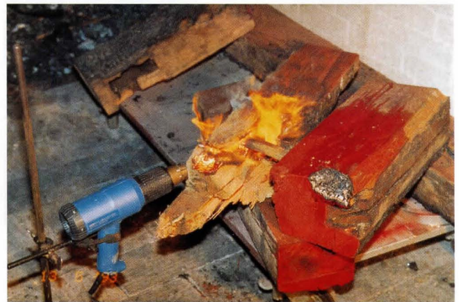
Bild 7: 3. Versuch-Flammenbildung 2 Minuten 40 Sekunden nach Versuchsbeginn
