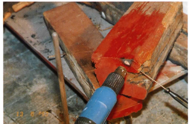
Bild 4: 2. Versuch-Glimmerscheinungen 2 Minuten 10 Sekunden nach Versuchsbeginn
