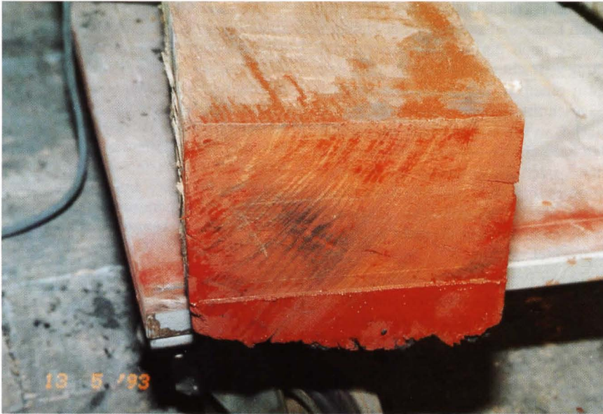
Bild 2: 1. Versuch-Versuchsende – Verfärbung des Holzes durch Wärmeeinwirkung
