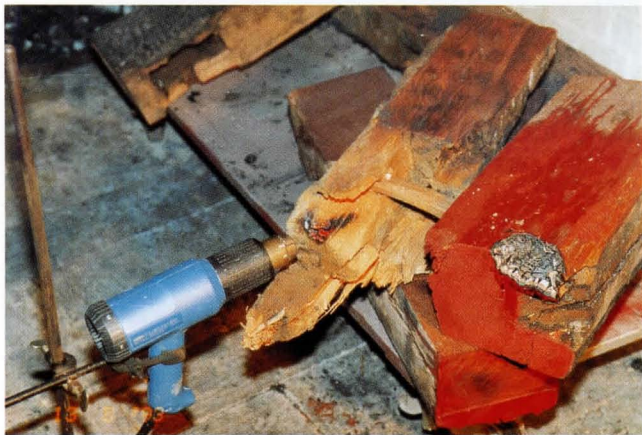
Bild 6: 3. Versuch-Glimmerscheinungen 40 Sekunden nach Versuchsbeginn
