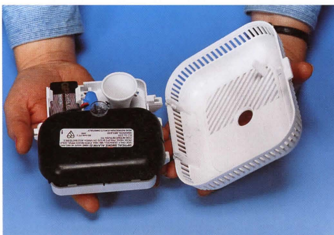
Rauchmelder– Innenansicht mit eingelegter Batterie
