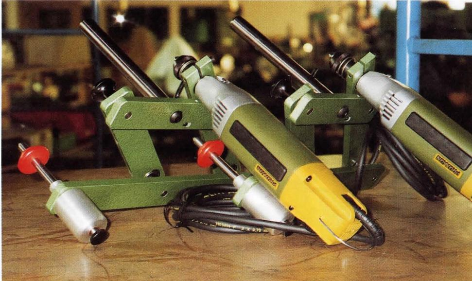
Phantograph mit Fräsmotor, das Herzstück des Codiergerätes
