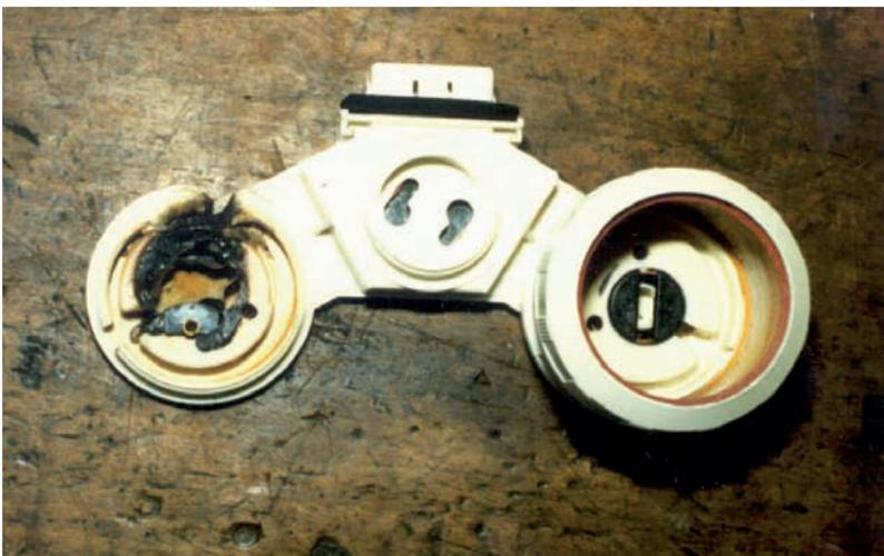
**Bild 4:** Brandschaden an der Fassung einer Leuchtstofflampen-Leuchte
