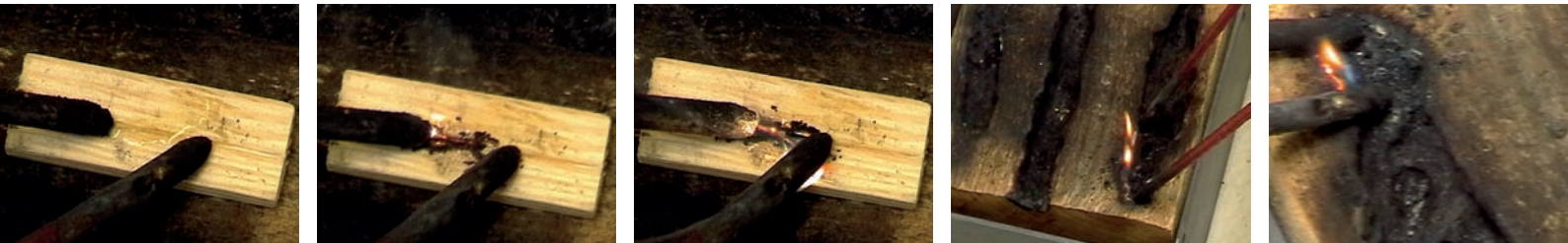
Bild 7: Durch Ströme < 300mA entflammtes Holz (Frequenzen ≠ 50 Hz) Bilder 1-3: künstlich gealtertes Holz. Bilder 4-5: Holzseite mit alten Brandspuren
