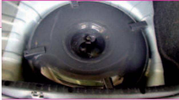
Bild 5: Flüssiggas-Tank
