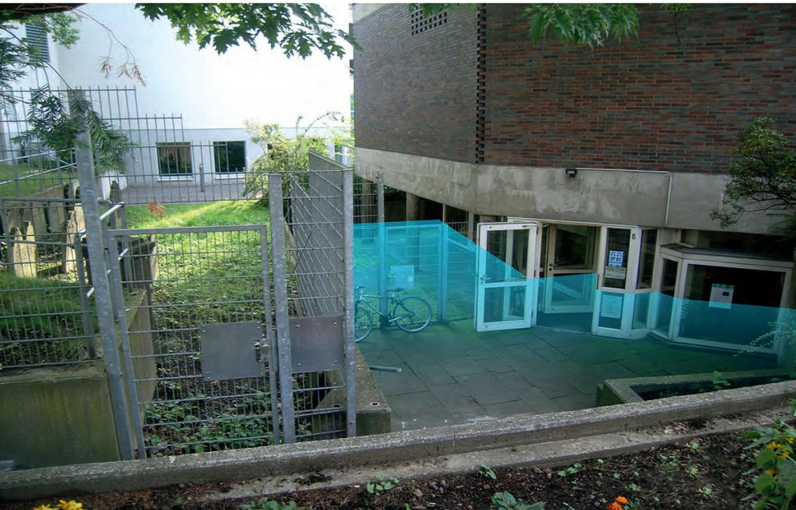
**Bild 6** | Anschaulich dargestellt: Die halbdurchsichtige Ebene zeigt, welche Baumaßnahme in Zukunft größere Schäden verhindern kann.
