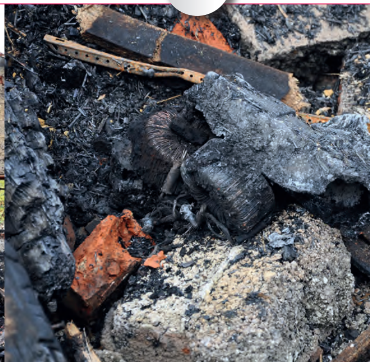
Bild 4 | Zwei Spulen, vermutlich aus einem Wechselrichter, wurden im Brandschutt gefunden.
