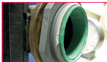
Bild 3 | Hier sind die abgebrochene PVC-Anschlusskupplung und die Werkzeugspuren auf deren Greiffläche zu erkennen.
