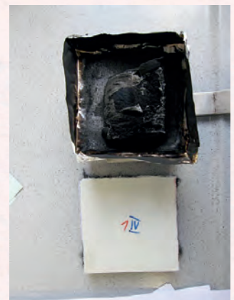
Bild 5 | Dämmprobe (10 x 10 cm) im Cone-Kalorimeter danach
