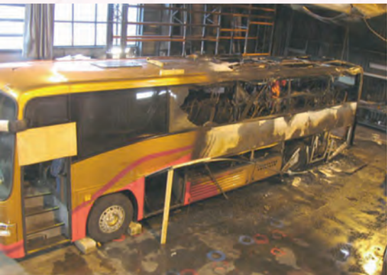
Bild 6 | Real-Brandversuch mit einem Bus beim SP Technical Research Institute of Sweden
