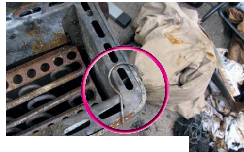
Bild 4 | Nicht brennbare Reste von Kleiderbügeln innerhalb eines Saunaofens belegen die missbräuchliche Verwendung der Sauna als Kleiderkammer.
