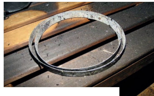
Bild 5 | Von einem hölzernen Aufguss-eimer, der sich zum Zeitpunkt der Inbetriebnahme einer Sauna auf dem Ofen befand, blieben nur die metallenen Ringe übrig.
