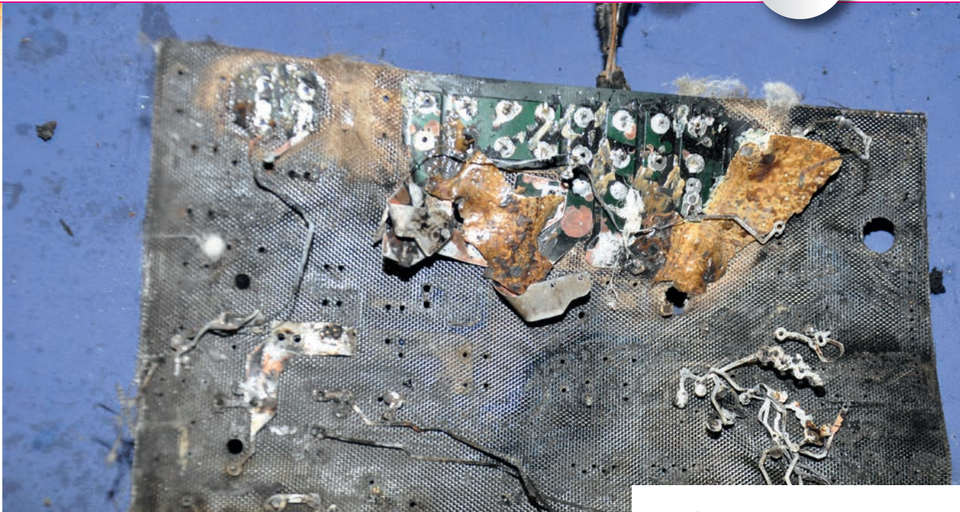
Bild 7 | Ansicht einer brandursächlichen Platine einer Saunasteuerung
