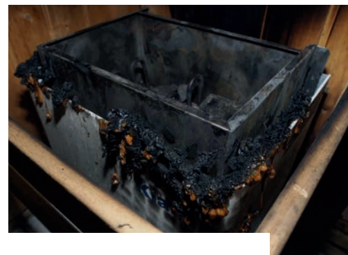
Bild 6 | Im vorliegenden Fall war es ein Teppich, der – möglicherweise bei Reinigungsarbeiten – auf dem Saunaofen abgelegt wurde und vor dem erneuten Einschalten der Sauna nicht wieder entfernt wurde.
