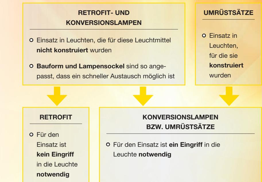
**Bild 2** | Merkmale und Unterschiede von Retrofitlampen, Konversionslampen und Umrüstsätzen
