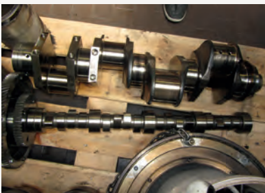
Bild 12 | Zugehörige Kurbelwelle und Nockenwelle wurden als Folgeschaden ebenfalls beschädigt
