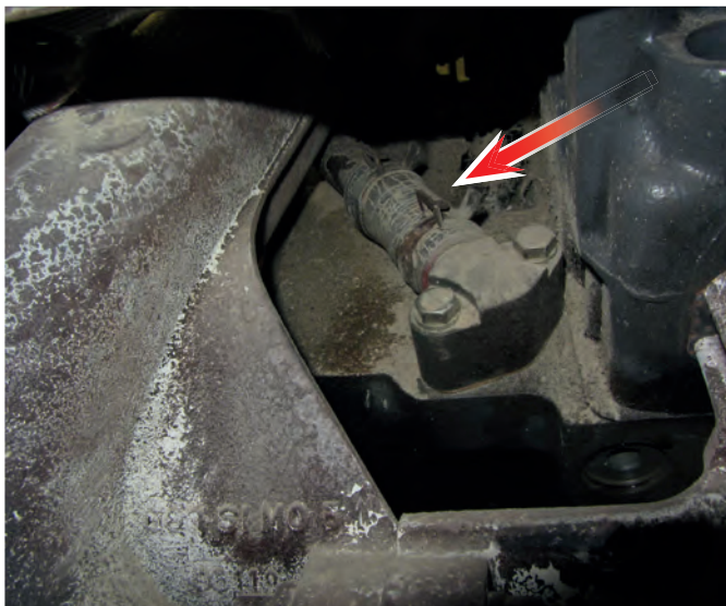
Bild 3 | Schmierölrücklaufleitung an einem Turbolader ohne ausreichende Abschirmung
