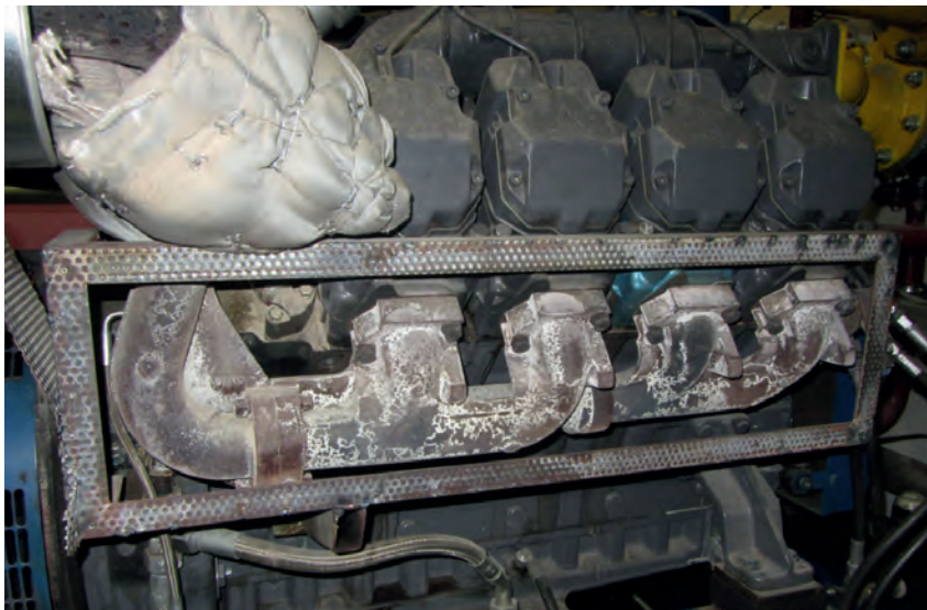
Bild 2 | Zündstrahlmotor älterer Bauart, abgeleitet von einem Baumaschinen-Antriebsmotor
