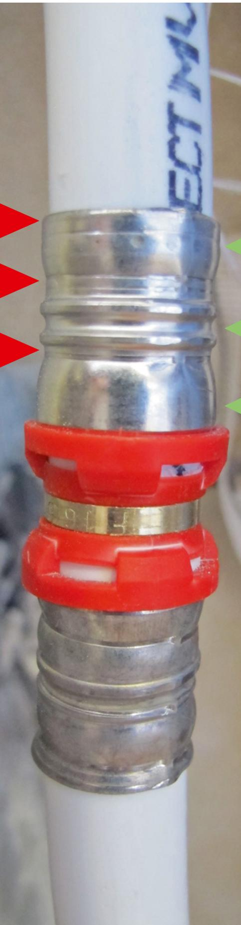
An den vier anderen Pressverbindungen des Asservates fielen zwei unterschiedliche Presskonturen auf (**Bild 2**). Wie die Gutachterin vom Hersteller erfuhr, ist bei dem verwendeten System sogar eine dritte, komplett andere Presskontur vorgesehen. Der Monteur hatte demnach ein ungeeignetes Werkzeug benutzt.
