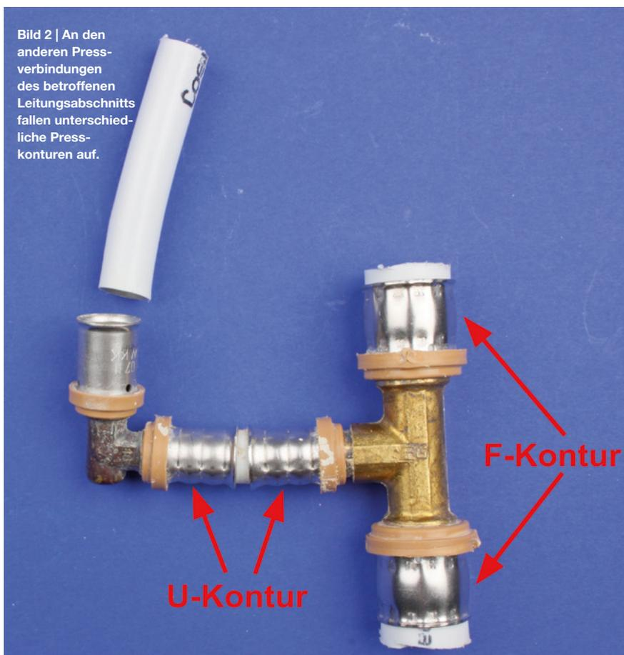
An der gelösten Verbindung war das Rohrende nicht rechtwinklig abgelängt und entgratet worden, wie es in der Montageanleitung vorgeschrieben ist. Zudem handelte es sich bei dem Mehrschichtverbundrohr um ein Produkt, das nicht für das verwendete System vorgesehen war.
