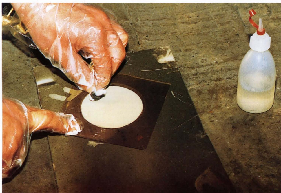
Abb. 10: Wischprobennahme von einer definierten Metalloberfläche
