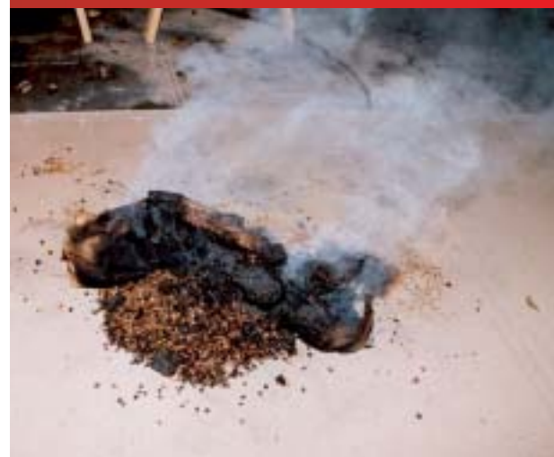
Bild 3 | Laborversuch des IFS: Nach dem Überhitzen im Mikrowellengerät geriet das Körnerkissen in Brand.
