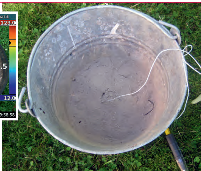
Bild 11 | In einem Metalleimer mit einem Aschebett und einer Aschebedeckung der glühenden Kohlereste liegt auch nach deutlich über 24 Stunden noch Glut vor.
