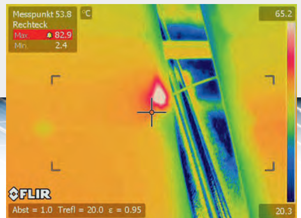
Bild 10 | Die gleiche Lötverbindung im Infrarotbild
