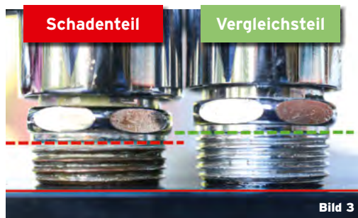
Bild 3 / Vergleich der Gewinde an den Rohrbelüftern zwischen dem Teil von der Schadenstelle (l.) und dem Vergleichsteil aus dem Labor (r.). Das rechte Gewinde ist etwa einen Gang länger.
