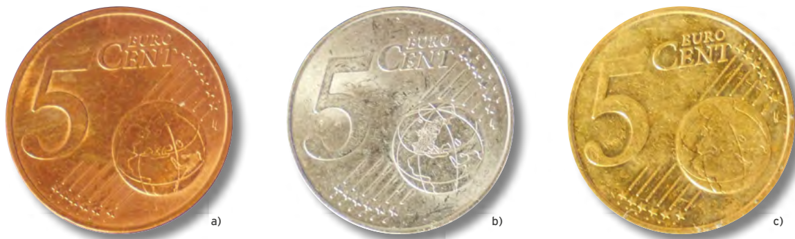
Bild 6 / Münzen aus dem Versuch „Vergolden einer Kupfermünze“ a) reine Kupfermünze, b) Kupfermünze mit Zinküberzug (scheinbar „versilbert“), c) Kupfermünze mit Messingüberzug (scheinbar „vergoldet“)
