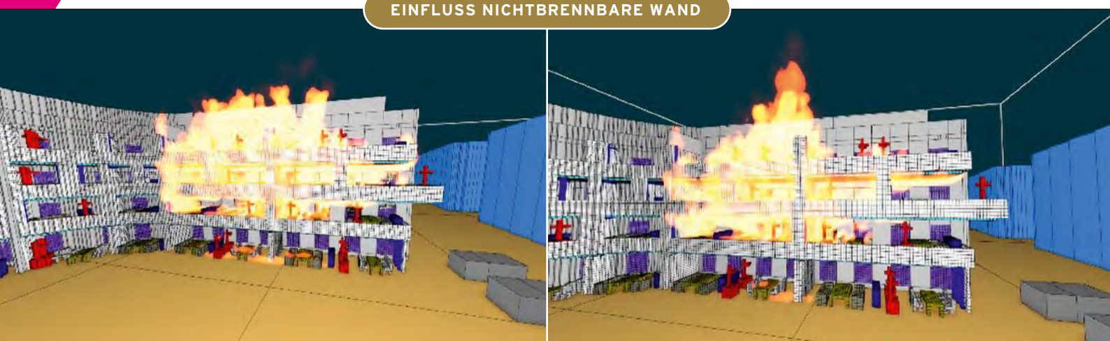
Bilder 2 und 3 / Flammenausbreitung über den Balkon mit Barriere an nichtbrennbarer Wand, links: mit Wind; rechts: ohne Wind
