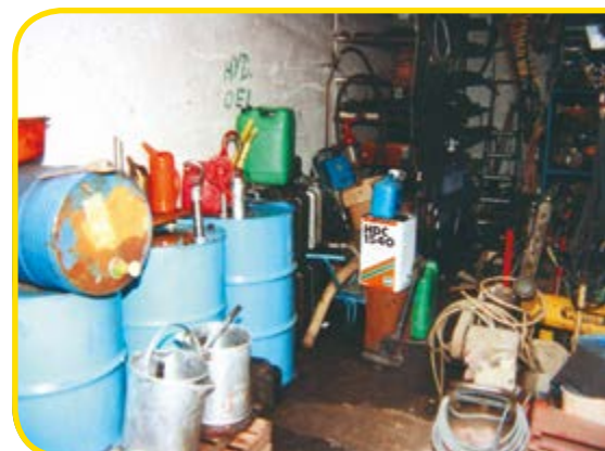
Bild 13 | Auch der Lagerung von Ölen, Lacken oder anderen wasser- und bodengefährdenden Stoffen sollte genügend Beachtung geschenkt werden.
