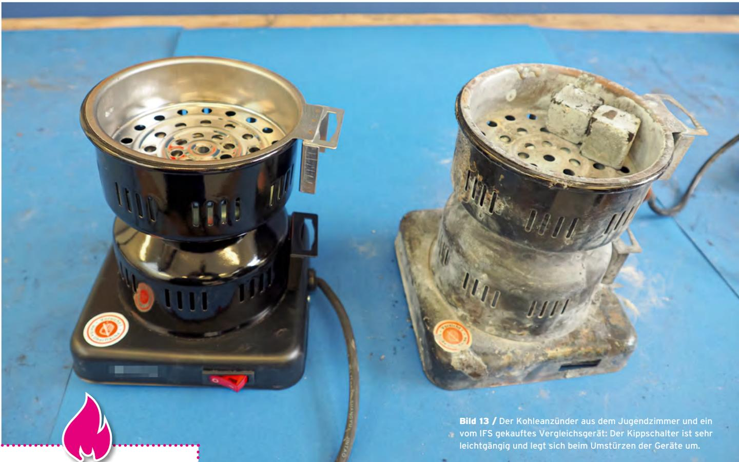
**Bild 13** / Der Kohleanzünder aus dem Jugendzimmer und ein vom IFS gekauftes Vergleichsgerät: Der Kippschalter ist sehr leichtgängig und legt sich beim Umstürzen der Geräte um.
