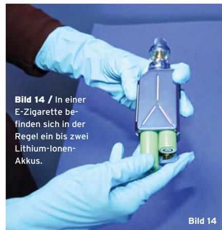
**Bild 14** / In einer E-Zigarette befinden sich in der Regel ein bis zwei Lithium-Ionen-Akkus.
