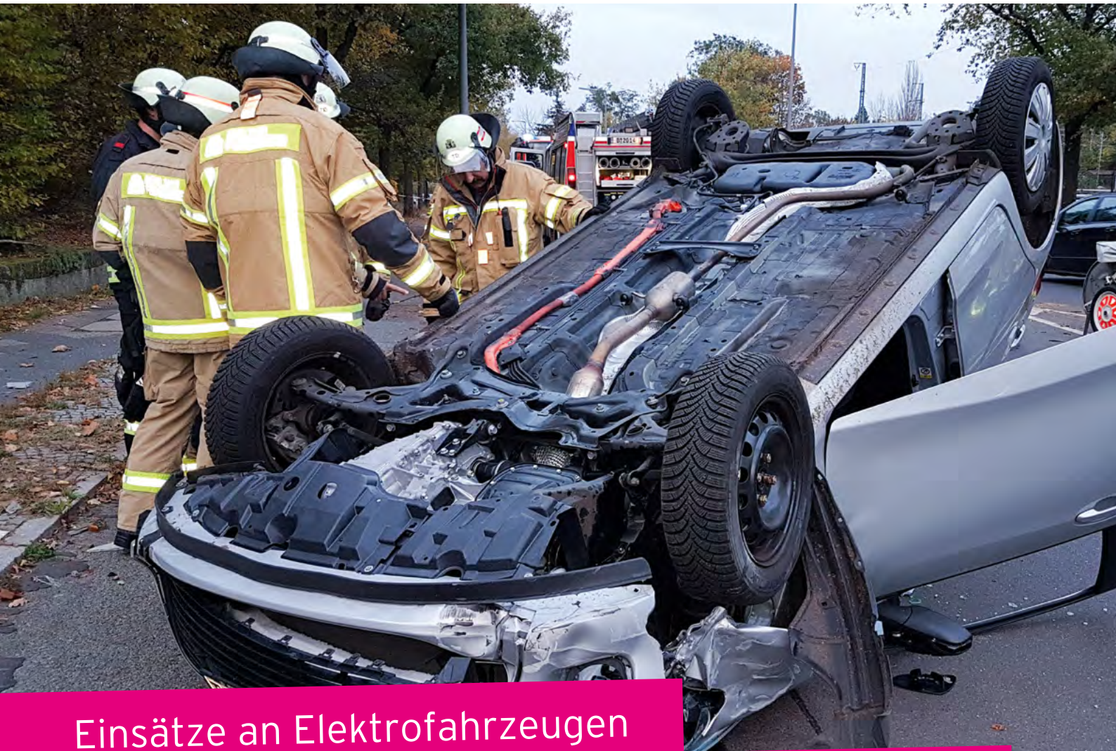
Bild 1 / Unfall eines Hybridfahrzeugs - oranges Hochvoltkabel an der Fahrzeugunterseite gut erkennbar
