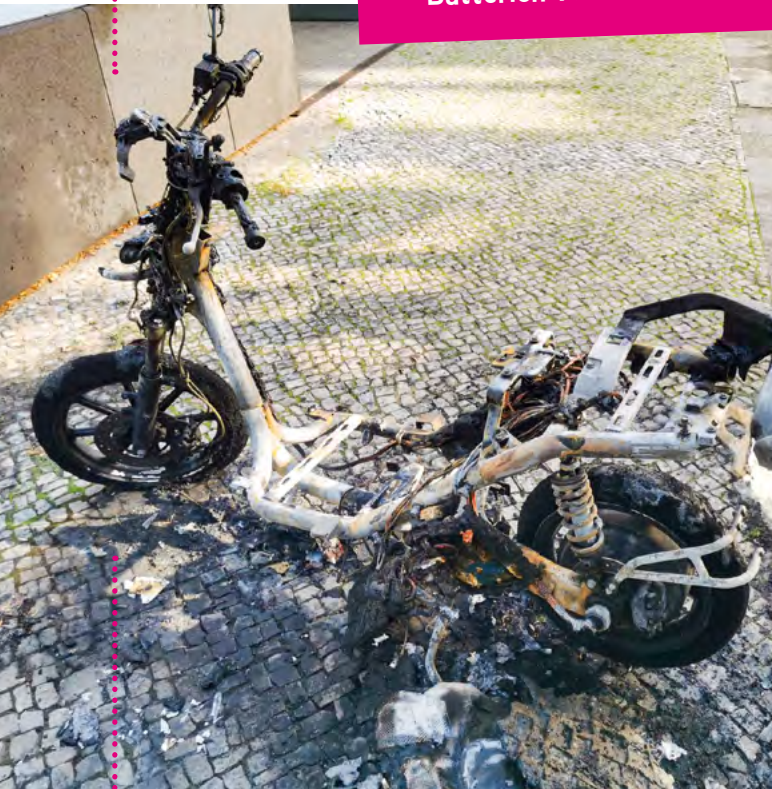
Bild 4 / E-Roller - komplett ausgebrannt, einschließlich der Batterie. Kontamination und Gefahrstoffe auf dem Gehweg
