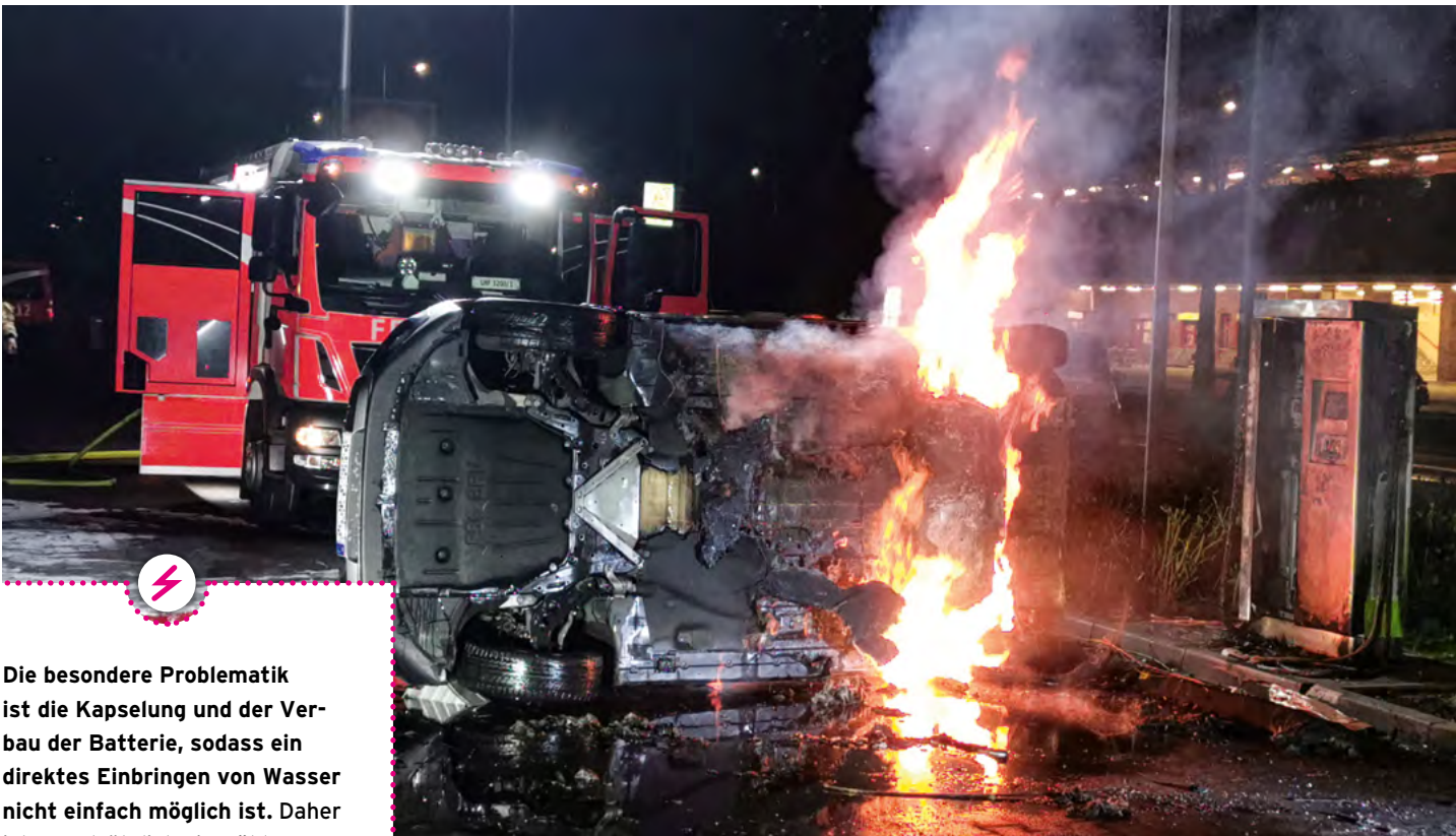
Bild 3 / Brennende Hochvoltbatterie. Wenn die Taktik „Ausbrennen lassen“ gewählt wurde, ermöglicht das Fahrzeug auf der Seite liegend eine bessere Kontrolle und ein Fahrzeug-Vollbrand wird verhindert.
