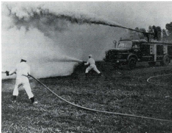
Bild 3. Löschangriff von einem Trockenlöschfahrzeug (Trolf) aus, mit Pulver- strahlrohren und dem Pul- verwerfer des Trolf. Aufn. Werkfoto Minimax AG.
