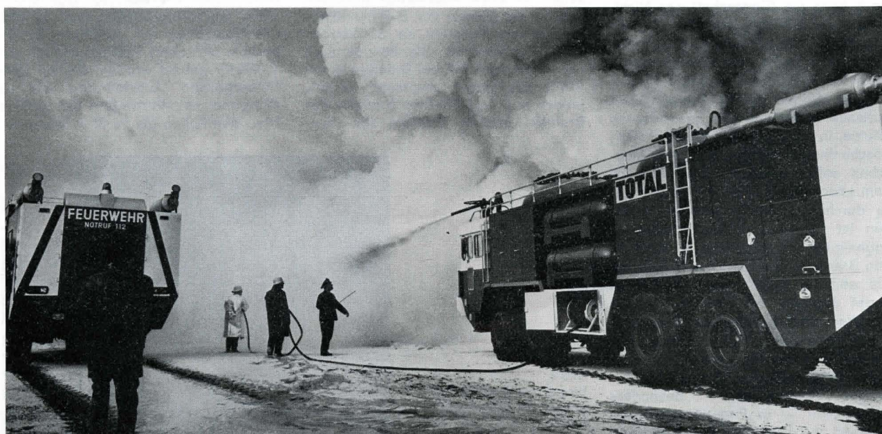
Bild 4. Größtes Trockenlöschfahrzeug mit einem Löschmittelvorrat von 12000 kg Löschpulver. Aufn. TOTAL-Foerstner & Co, Ladenburg.
