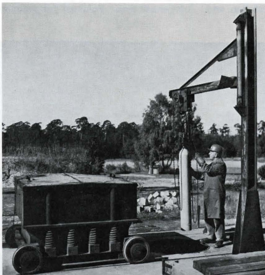
Bild 7. Versuchsstand für Zündversuche an Acetylenflaschen zur Prüfung der sichernden Wirkung poröser Füllmassen. Absenken einer für den Zündversuch vorbereiteten Acetylenflasche.
