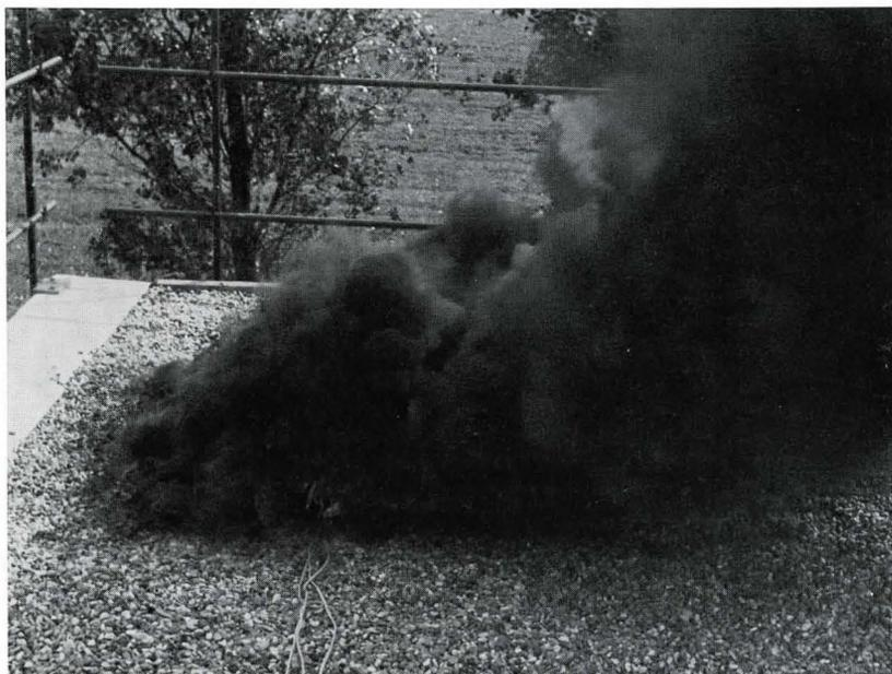
Bild 9. Die gesamte GFK-Lichtkuppel ist in Brand geraten. Die intensive schwarze Rauchentwicklung schränkt die Beobachtung des Brandverhaltens sehr stark ein.
