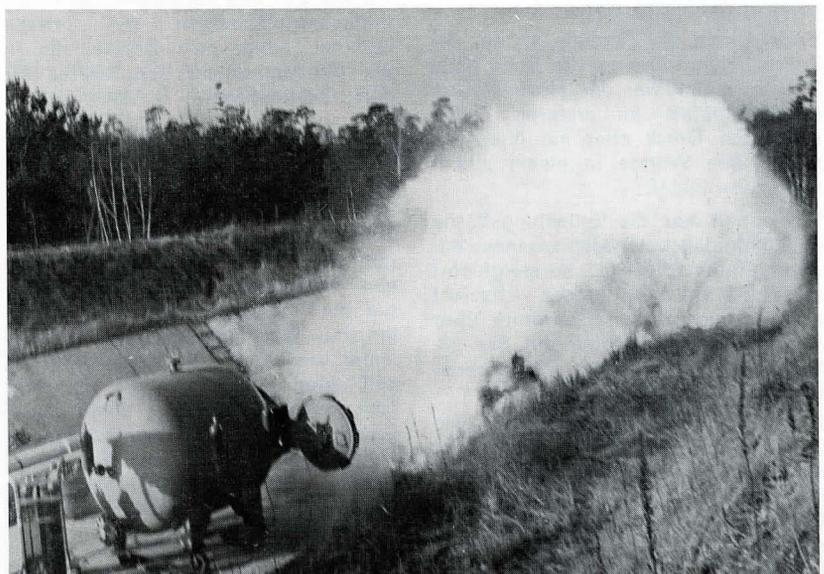
Bild 11. Flammenausbreitung bei Druckentlastung von Staubexplosion und Nachverbrennung von ausgeworfenem Staub (nach Versuchen von M. Hattwig).
