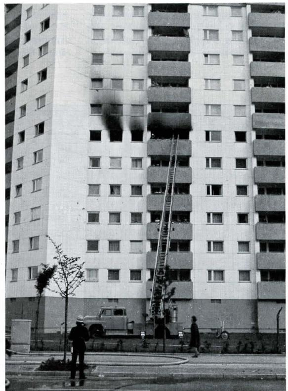
Bild 5. Hubrettungsfahrzeug im Einsatz auf einer Aufstellfläche.
