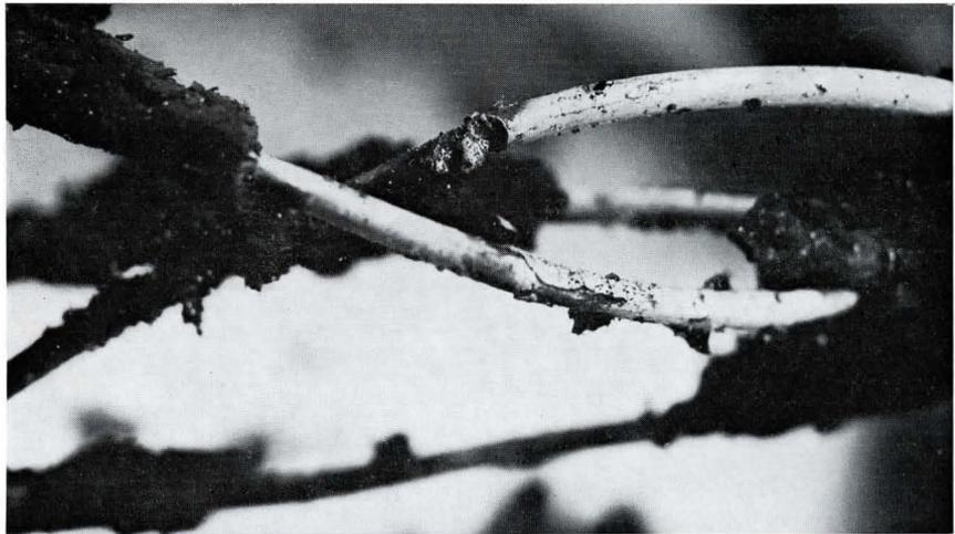
Bild 8. Anschmelzungen an den Kupfer-Leitern infolge Auftreten eines Lichtbogenkurzschlusses.
