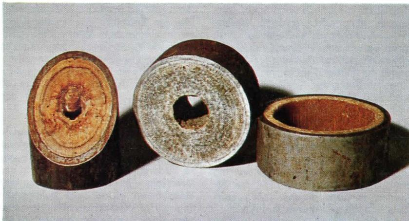
Bild 11. Warmwasserrohre mit Steinablagerungen.
