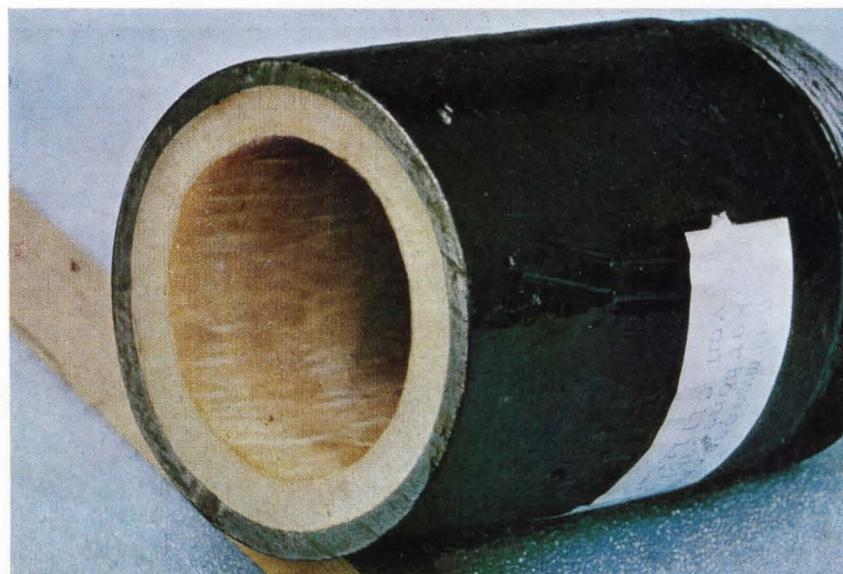
Bild 10a. Karbonatablagerungen in einem Wasserrohr, die durch Phosphat-Behandlung teilweise abgebaut wurden.
