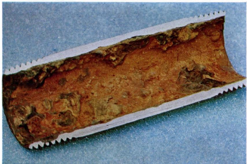
Bild 8. Korrosion durch aggressives Wasser.
