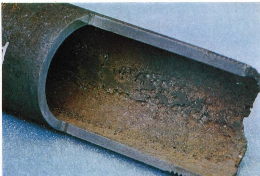
Bild 9. Korrosion durch aggressives Wasser.
