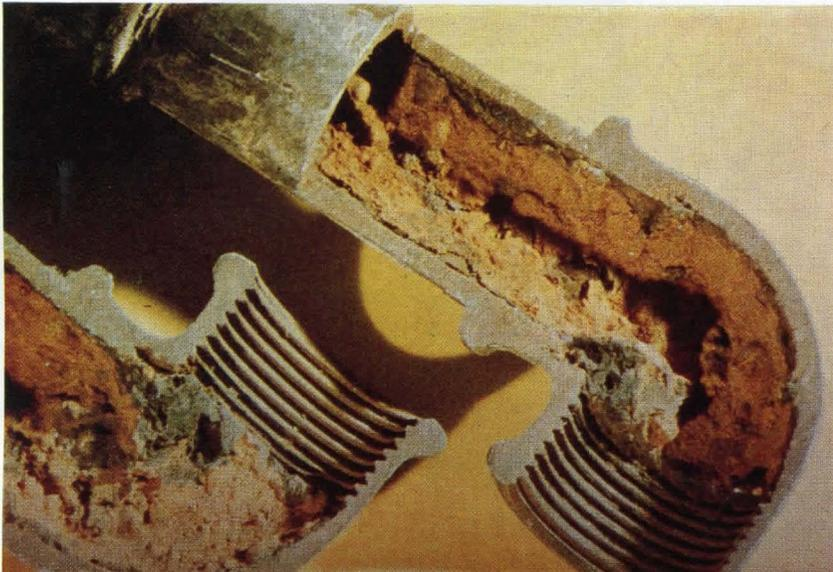
Bild 4. Korrosion in einer Rohrleitung.
