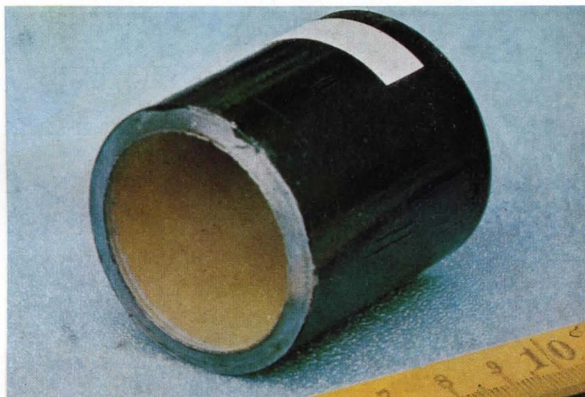
Bild 10. Warmwasserrohr mit Phosphat-Schutzschicht.
